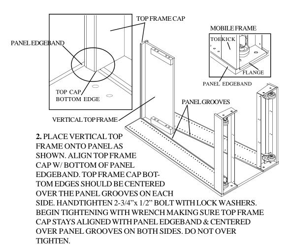
3. PLACE MOBILE FRAME ON PANEL AS SHOWN. FRAME FLANGE **SHOULD REST SNUG AGAINST** PANEL. ALIGN TOE KICK WITH PANEL EDGE-BAND. HAND TIGHTEN 1"-1/2" **BOLT WITH LOCK** WASHER. BEGIN **TIGHTENING** WITH WRENCH **MAKING SURE FLANGE STAYS SNUG AND** TOEKICK RE-MAINS ALIGNED. DO NOT OVER TIGHTEN.
